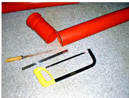
Для изготовления входного и выходного патрубков достаточно было ножовкой по металлу отпилить пару отрезков канализационной трубы, вставить их в муфты и закрыть заглушками.
