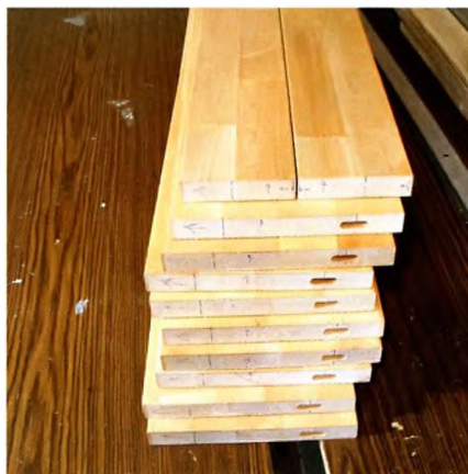
Разметка точек крепления полки. Пазы обеспечат смещение материала при изменении влажности.
