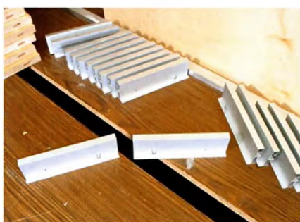
В профилях для полок по два отверстия: для жёсткого крепления саморезом и для винта с гайкой.
