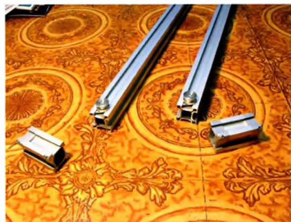
В пазы несущих стоек установлены закладные гайки, удерживающие ролики. Ролики — часть соединителя.
