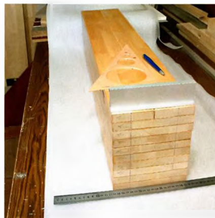
Разметка точек крепления полок на торцах.
