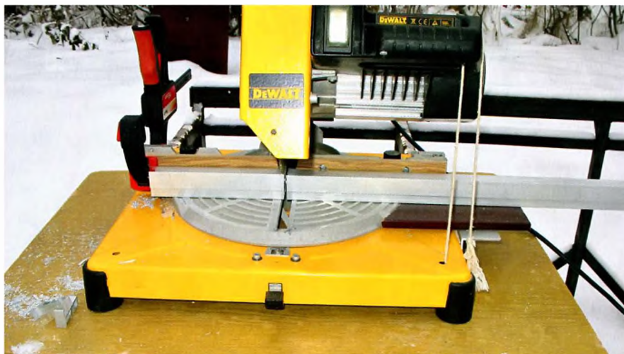
Резка профиля для полок в размер.
