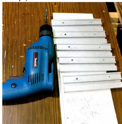
Сверление отверстий в профилях для крепления полок.
