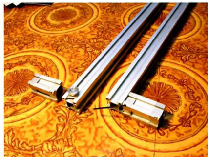
Соединитель надевают на ролики и затягивают двумя винтами с внутренним шестигранником.
