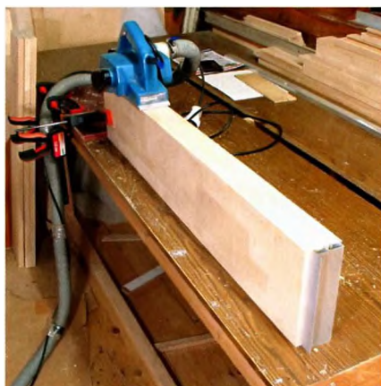
Строгаем кромки деревянных полок.
