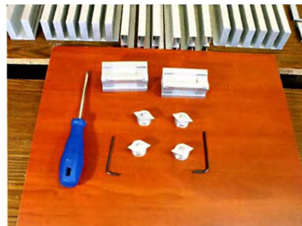
К несущему профилю элементы крепят с помощью закладной гайки в виде ромбика.
