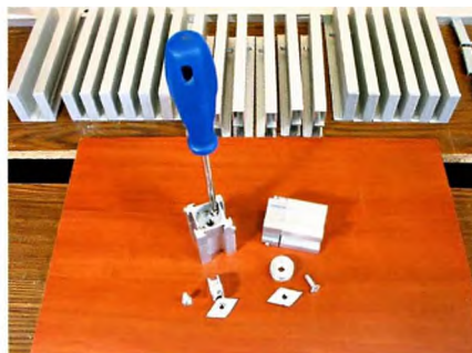
Сборка горизонтальных частей профиля (у стены).
