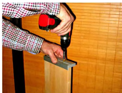
Крепление планки к торцу полки саморезом.
